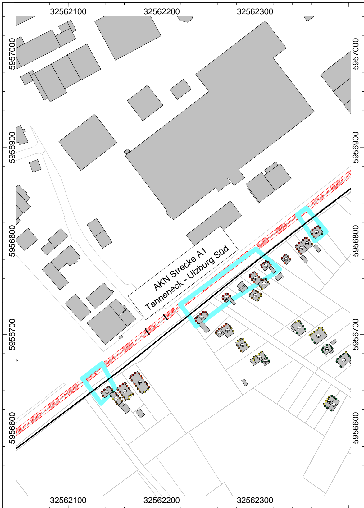
Abbildung 12: Bereiche mit Lärmkonflikten, Prognose-Nullfall 2015, AKN Strecke A1 zwischen Tanneneck und Ulzburg - Süd, westlich der Bundesautobahn A 7, M 1 : 2.500
